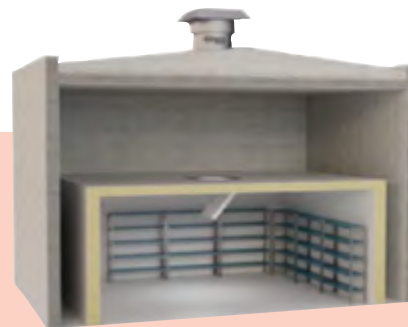
▲ Sección de planta alimentaria. De interior a exterior: cámara frigorífica, plénium, cerramiento general del edificio
